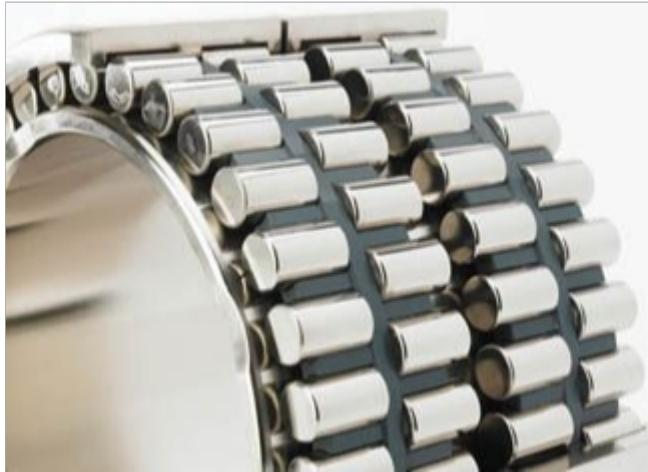
精密轴承按照ISO的分级标准分为P0,P6,P5,P4,P2.等级依次增高，其中P0为普通精度，其他等级都是精密级别。精密轴承与普通轴承应从以下几点来进行区分：1、尺寸要求值不一样，精度等级高的产品其尺寸偏差（内径、外径、椭圆等）都比精精密轴承度等级低的产品要求的值要小；2、旋转精度的要求值不一样，精度等级高的产品其旋转精度（内径向跳动、外径向跳动、端面对滚道的跳动等）都比精度等级低的产品要求的值要严；3、表面形状和表面质量的要求值不一样，精度等级高的产品其表面形状和表面质量（滚道或沟道的表面粗糙度、圆形偏差、沟形偏差等）都比精度等级低的产品要求的值要严；4、精度等级特别高的产品其材料要比一般精度等级的产品的材料性能更为有利。北京角接触轴承用途无锡轴研所轴承报告。
